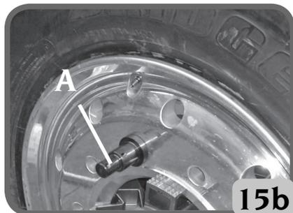
Pour des jantes fragiles ou particulièrement fines, il est recommandé de diminuer cette pression ; Pour des jantes à large épaisseur et étant difficiles à démonter, il est conseillé de régler la pression au maximum.
