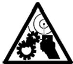
Machine avec mouvements commandés à distance.
